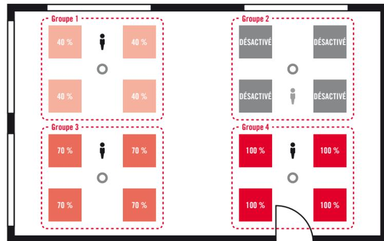
Chaque détecteur de présence assure une régulation individuelle de la luminosité en fonction de la présence et de la lumière ambiante dans sa zone grâce à un capteur infrarouge passif et à un capteur de luminosité intégrés. Si aucune personne n'est présente, comme dans la zone du groupe 2, l'éclairage reste éteint.
