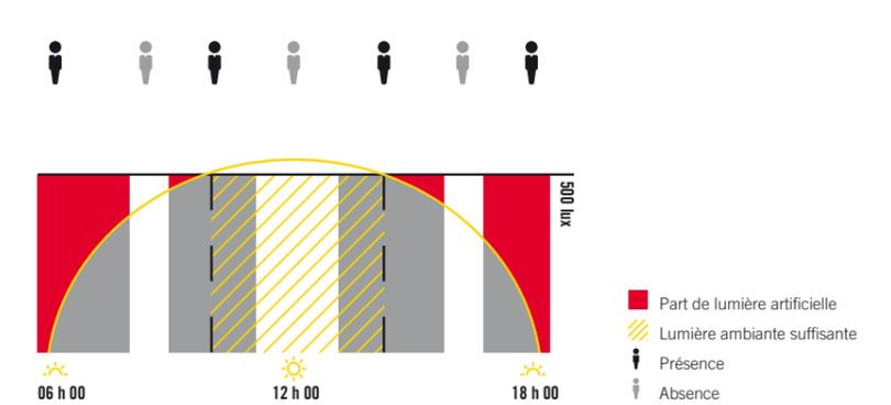
La forme de commande d'éclairage la plus efficace en énergie : régulation constante de la luminosité d'un détecteur de présence en fonction de la présence et de la lumière ambiante.
